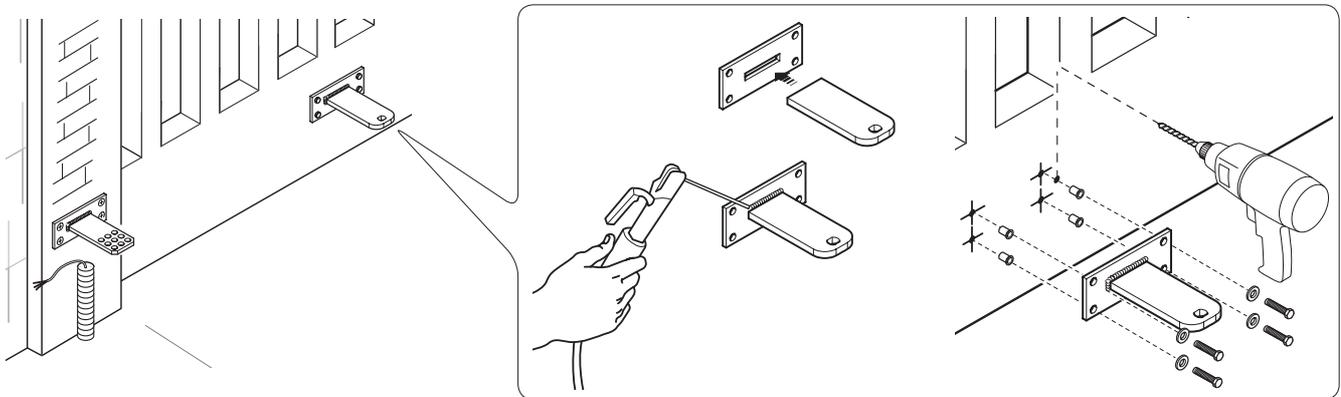
Introduisez la bague (graissée) dans le trou de l'étrier pilier. L'étrier est muni de trous qui permettent de varier l'angle d'ouverture du portail.
