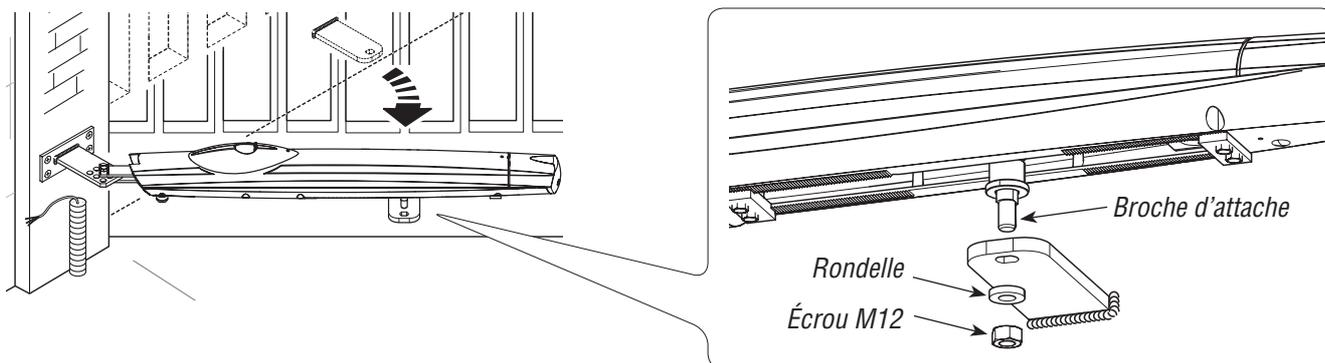
Débloquez le motoréducteur (voir paragraphe débloquage manuel), mettez la porte en position d'ouverture maximale, desserrez les écrous de l'arrêt mécanique d'ouverture, placez-le en butée avec la broche d'attache et fixez-le.
