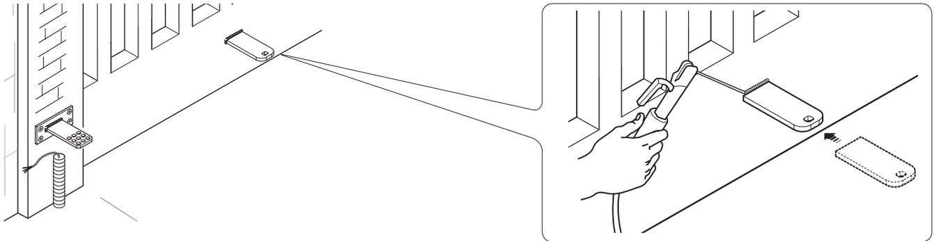
N.B. : sur les portes qui ne sont pas en métal, assemblez et soudez les deux parties de l'étrier et fixez-les avec les vis appropriées.
