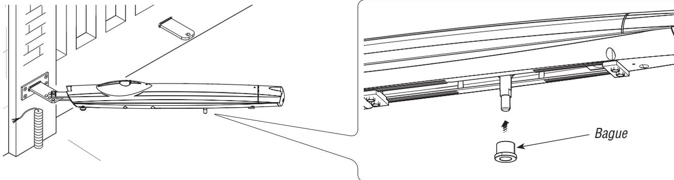
Ouvrez la porte et introduisez la broche dans l'étrier portail. Fixez-la avec la rondelle et l'écrou.
