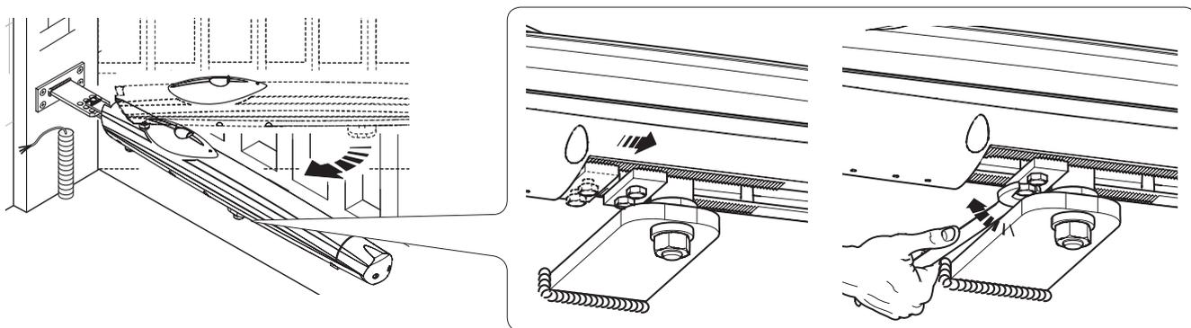
Mettez la porte en position de fermeture, desserrez les écrous de l'arrêt mécanique de fermeture, placez-le en butée avec la broche d'attache et fixez-le.
