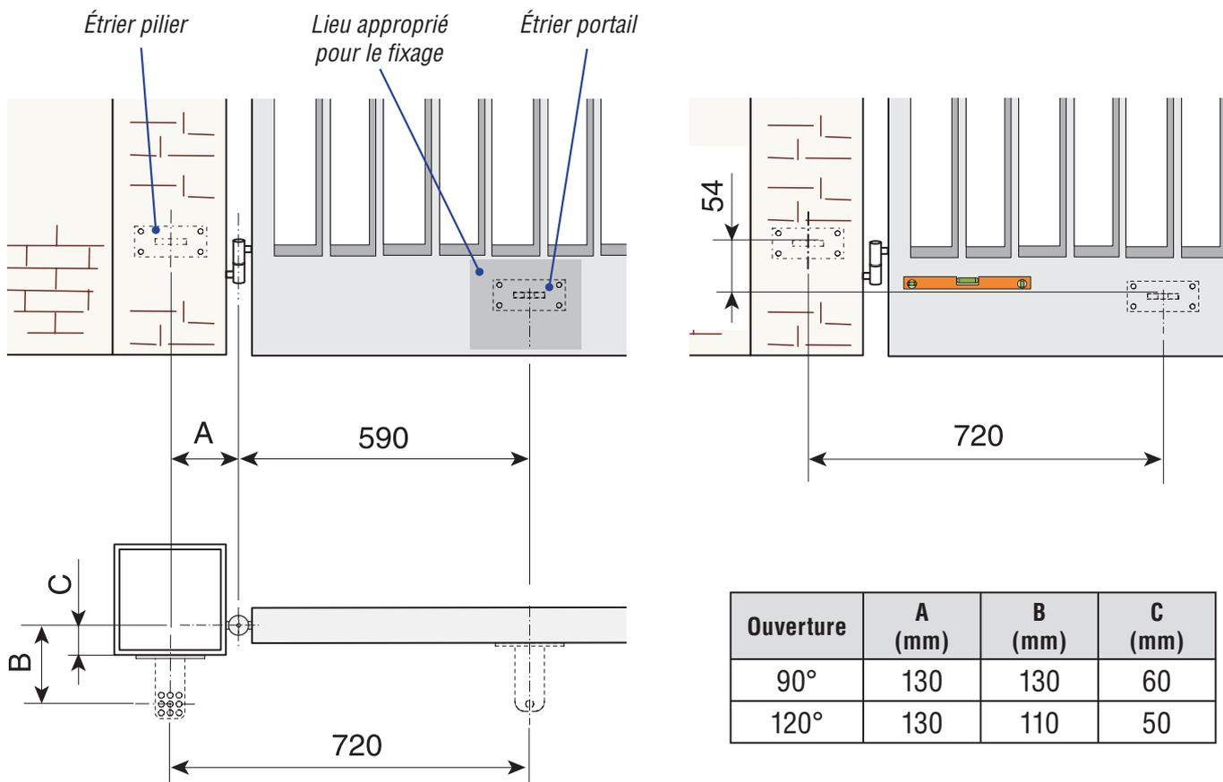
Assemblez et soudez les deux parties de l'étrier pilier. Sur le lieu préalablement défini fixez l'étrier avec les chevilles et les vis appropriées ou – si le pilier est en métal – soudez-le.
